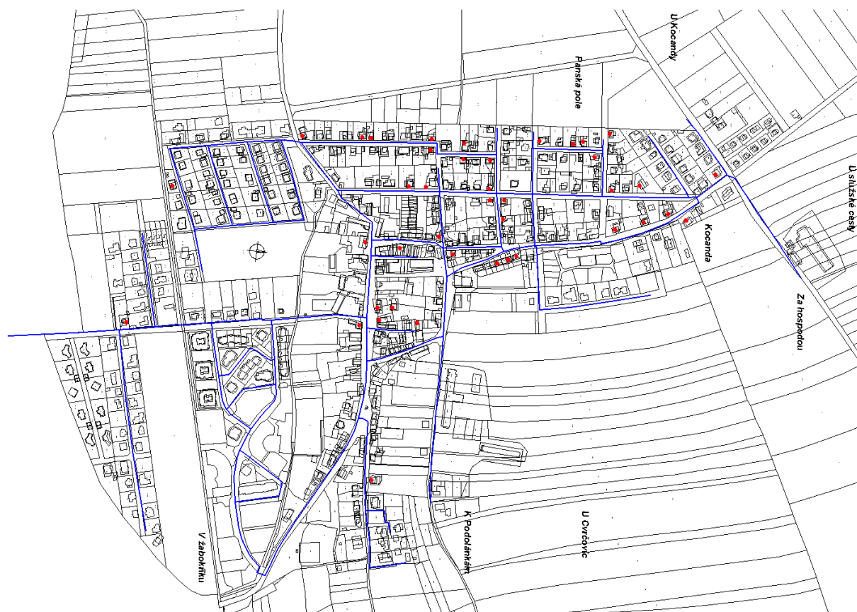
Obr. 5: Rozložení paušálních odběrů na vodovodní síti ve stávajícím stavu.
